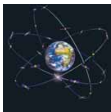
GALÍLEÓ Kerfið byggir á svipaðri tækni og GPS, og notar gervihnetti á braut um jörðu til að staðsetja hluti. MYND/ESA
