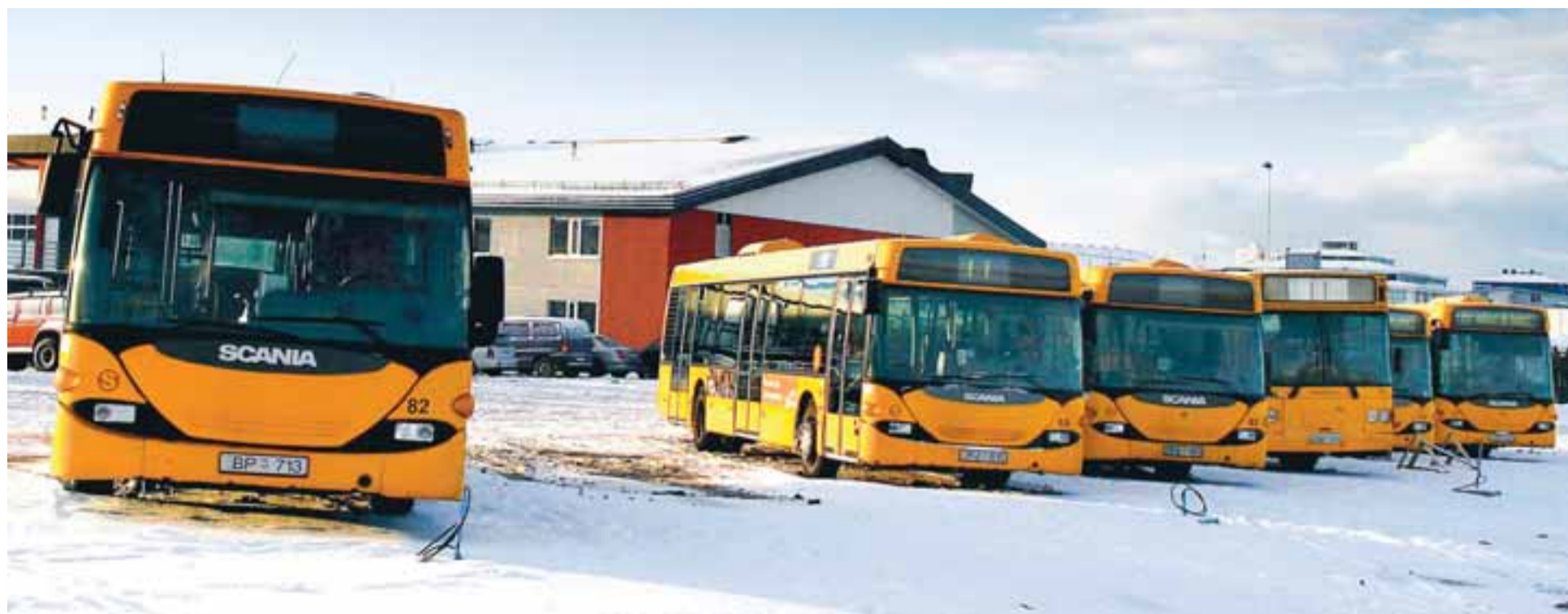
Vagnarnir standa á upphituðu plani og eru tengdir lofti og rafmagni í stæðum sínum.
