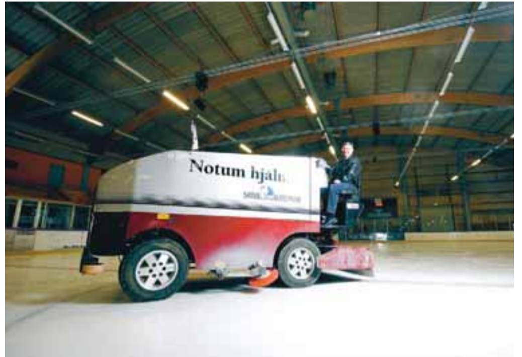
Íshefillinn sem hefur þjónað Skautahöllinni í Laugardal undanfarin ár er af gerðinni Olympia, sem er kanadískt merki, og er drifinn áfram af própangasi.
