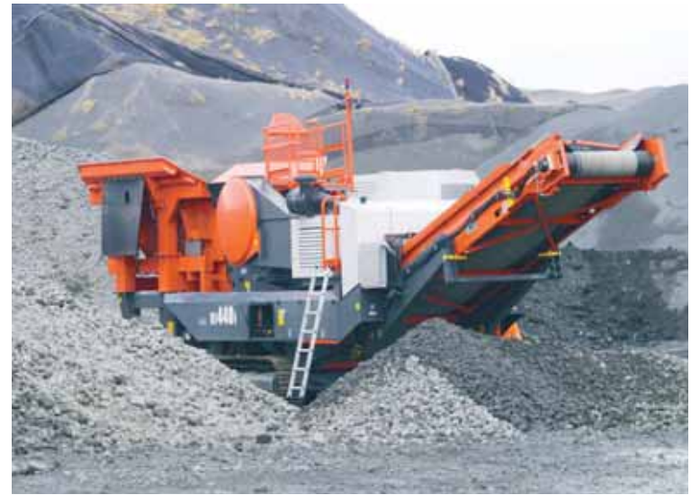
Sandvik UJ440i er kjálkabriótur sem tekur við grófasta efninu á fyrsta stiginu.
