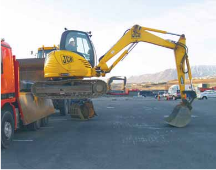
Hér mjakar Grímur Grétarsson sér ofan af vörubílspalli á beltagröfu, án utanaðkomandi hjálpar.
