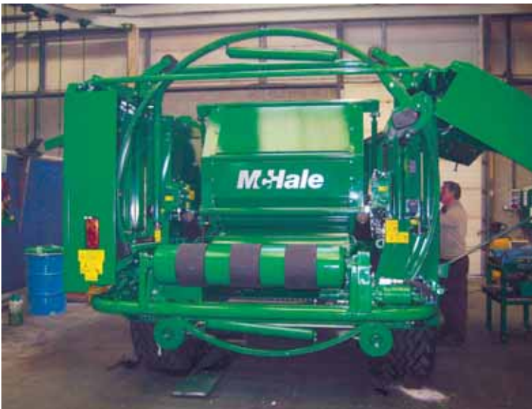
Fusion 2 er nýuppfærð gerð af sambyggðri rúllu- og pökkunarvél. Í vélinni er einfölduð stjórnölvla á íslensku með myndrænu viðmóti.
