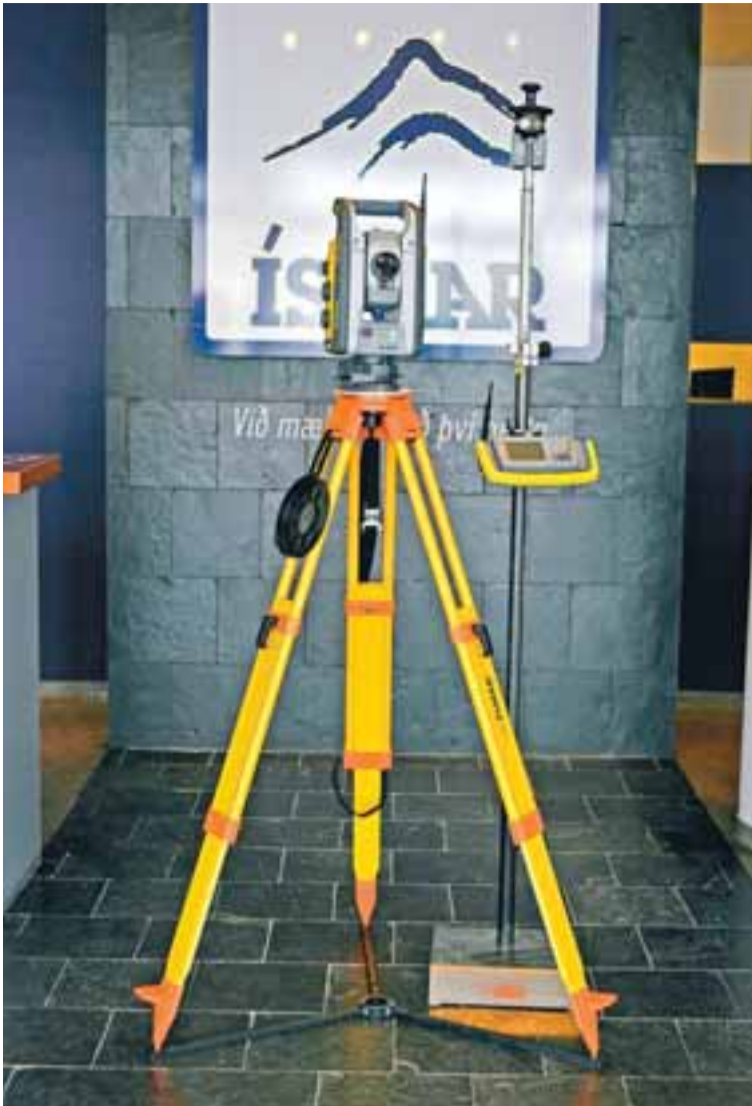
Hér má sjá uppsettan útsetningarbúnað fyrir byggingar.
