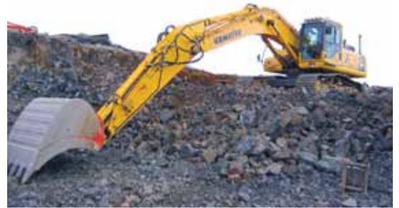
Árni Helgason ehf. á Akureyri er með þrjú Topcon GPS-kerfi en hérna sést Komatsu PC350LC-8 vél sem er með slíkan búnað. MYND/KRAFTVÉLAR EHF.
