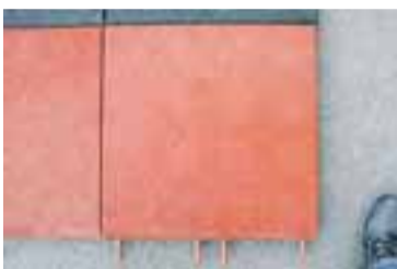
Hellurnar í Steinasteini eru festar saman með tökkum þannig að úr verða þungar mottur sem missiga síður en ef hellurnar eru lagðar hver fyrir sig.
