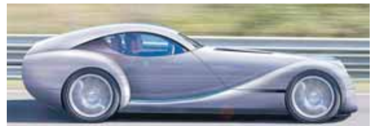
Morgan LIFE er vetnisrafdrifinn, smíðaður úr áli, viði og leðri. Kemst 400 kílómetra á einni hleðslu og nær 140 kílómetra hraða á klukkustund.
