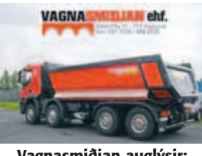
Vagnasmiðjan auglýsir: Eigum á lager hina grimmsterku Íslands-grjótpalla úr Hardox 450 og Domex stáli. Þyngd með sturtgrind og tjakk aðeins 2,9 tonn. Passar á alla 4ra öxla bíla. Nýsmíði og viðgerðir á öllum gerðum palla. Setjum slítstál innan í gamla palla. Gæði og gott verð. Vagnasmiðjan.is Eldshöfða 21 R.vík s. 587-2200, 898-4500.
