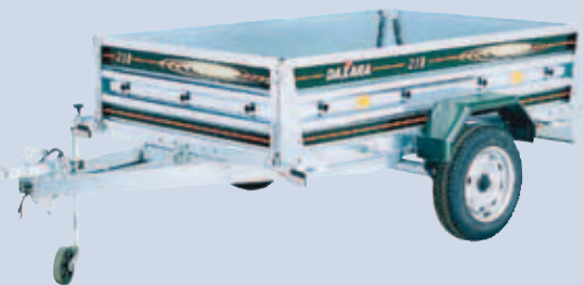
DAXARA 218 Sturtubúnaður, 13" dekk, opnanl. gafl framán og aftan Innanmál 204x129x40 cm Burðargeta 560 kg
