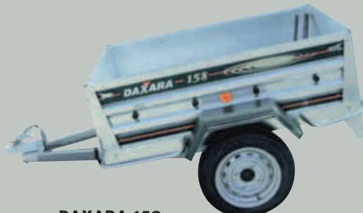
DAXARA 158 Sturtubúnaður, 13" dekk, opnanl. gafl framán og aftan Innanmál 145x100x40 cm Burðargeta 540 kg
