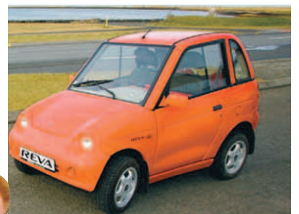
Reva City Car-bílur er stungið í samband við venjulega innstungu. Hann kemst á 60 til 70 kílómetra hraða.
