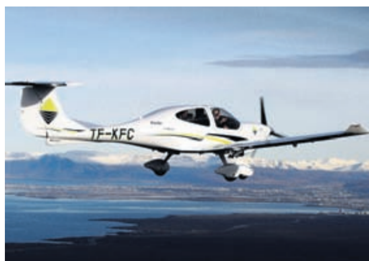
DA-40 TDI KENNSLUFLUGVÉL Vel viðraði í kynningarflugi nýrra kennsluflugvéla Flugakademíu Keilis í gær. Hér má sjá fjögurra sæta DA-40 TDI vél, sem búin er nýjustu tækjum og með bók úr koltrefjum, sem eru sterkari en ál, með höfuðborgina í baksýn. FRÉTTABLAÐIÐ/GVA
