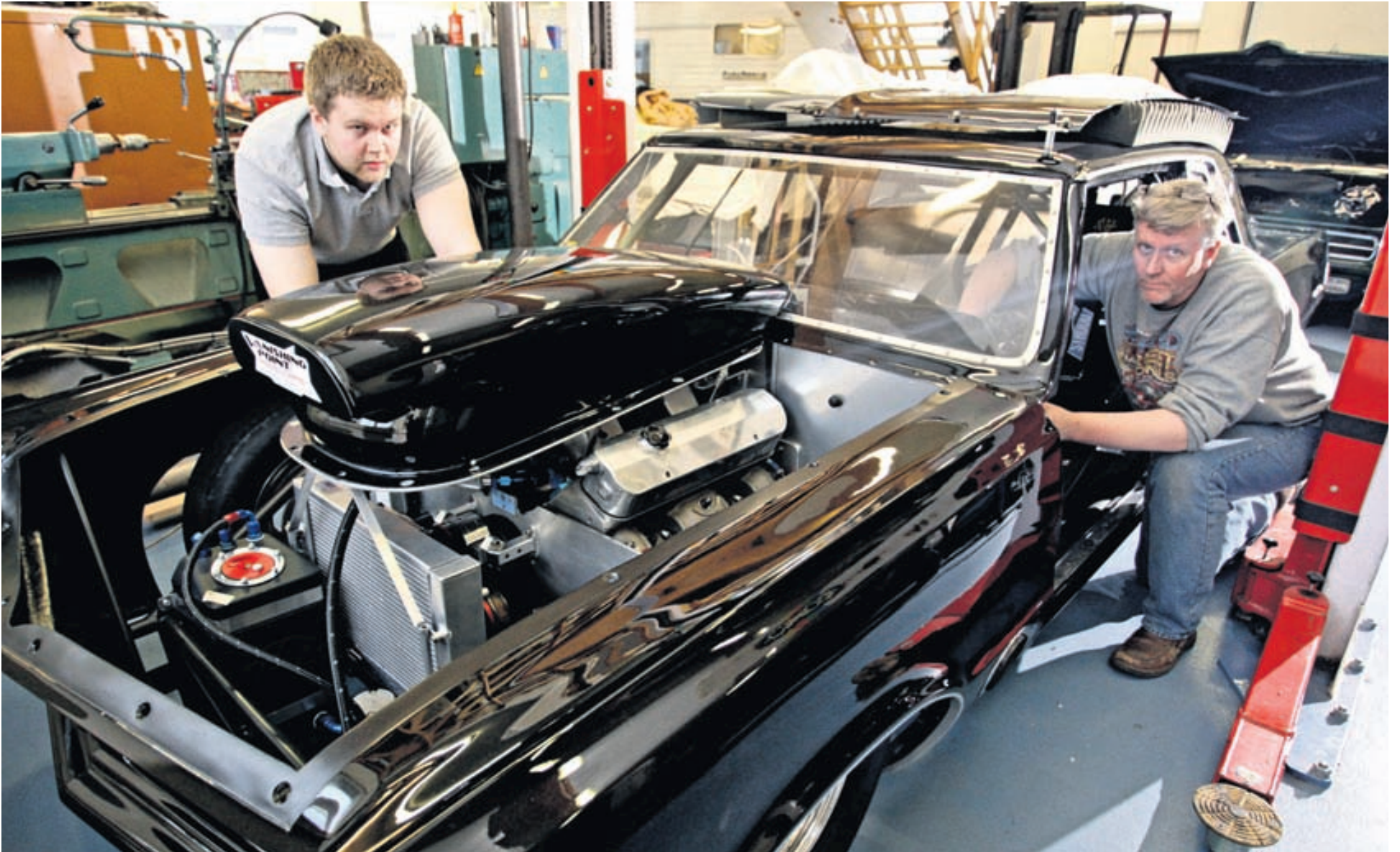
„Þetta er tæki með 1100 hestafla vél – alvöru kvartmílubíll, byggður frá grunni,“ segir Rúdólf um kvartmílubíllinn sem hann og sonur hans Kristinn, til vinstri, hafa verið að smíða síðustu ár.
