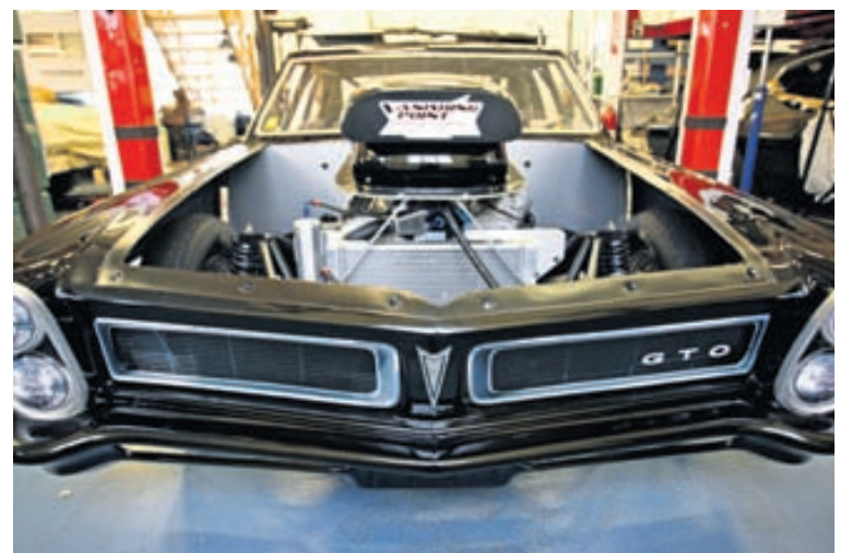
Bíllinn er í raun eftirlíking af Pontiac GTO 65 nema boddíð er allt úr plasti og burðarvirkið úr rörum, að sögn Rúdólfs.
