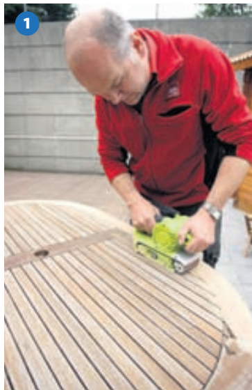
1 Hlynur byrjar á því að slípa borðið upp með skriðdreka og notar til þess grófan pappír. Skriðdrekan má ýmist kaupa eða leigja í Húsasmíðjunni.
