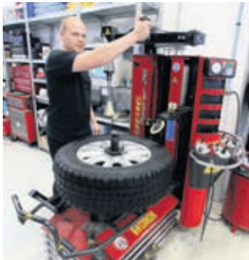
Fullkomin Artiglio Master dekkjavél sér til þess að felgurnar skemmist ekki við umfelgun.
