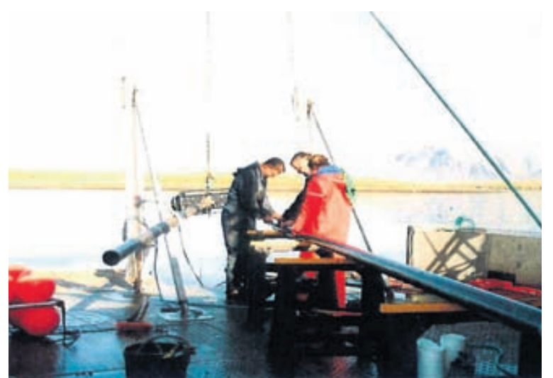
AÐFERÐIN Soga á sand af hafsbotni og skilja seguljárnin frá með seglum áður en sandinum er dælt aftur niður á botn.
