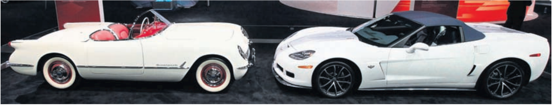
1953 Chevrolet Corvette frá 1953 og sextíu ára afmælisútgáfa 2013 Corvette 427 Convertible Collectors Edition. Hin nýja Corvetta er með 505 hestafla 7 lítra LS7 V-8 vél og er því hraðasti blæjubíllinn í sögu Corvette.
