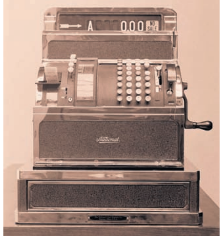
Fyrstu kassarnir voru handvirkir og sveifin tengd við sölutakann svo ekki væri hægt að opna þá án þess að sala hefði farið fram.
