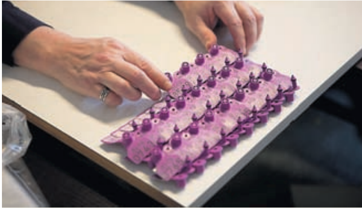
Plastiðjan Bjarg framleiðir búfjármerki fyrir íslenska bændur. Merkin eru flutt inn tilsteypt en í þau eru brenndar merkingar á staðnum eftir pöntun hvers bónda.
