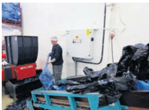
Notað plast er malað og öðlast nýtt líf í endurvinnsluhluta Plastprents.
