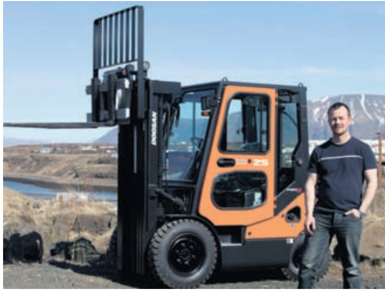
Birgir Árnason við hlið tveggja og hálf tónna dísellyftara með 3,3 lítra eyðslugrönnum Yanmar mótör og snúningi framan á gálganum frá Fjaðrabúðinni.
