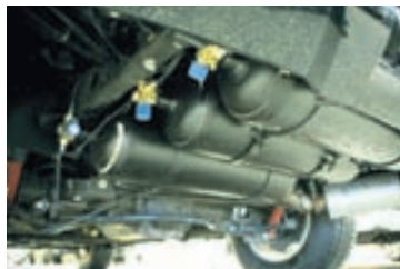
Metankútur er komið fyrir á snyrtilegan máta undir bílnum.
