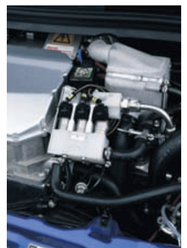
Vetnisbíll er knúinn rafmótor. Vetni er sett á geymslutanka bílsins og því svo umbreytt í raforku í sérstökum efnarafal.
