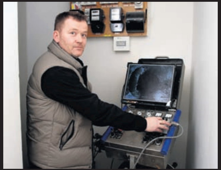
SNIÐUGUR TÆKJABÚNAÐUR Til að athuga hvort allt sé með felldu í lögnum getur Gísli beitt sérstakri myndavél.
