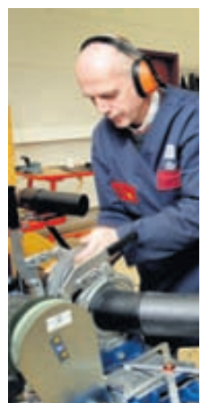
UNNIÐ VIÐ RÖRIN Nemandi að sjóða lagfirni á verkstæði skólans.
