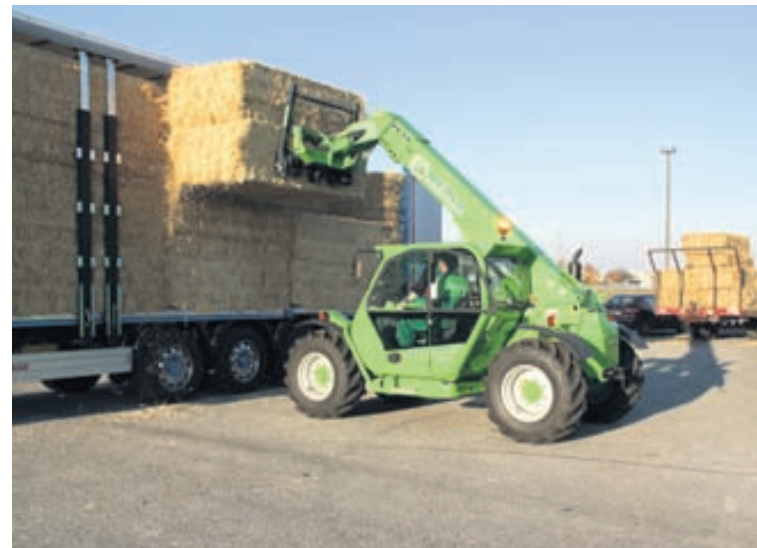
Lyftararnir eru fánlegir með lyftigetun frá 2,5 upp í 12 tonn og með lyftihæð allt að 18 metrum.
