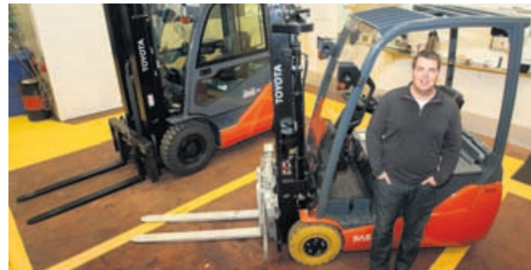
Á myndinni stendur Viktor Karl Ævarsson, sölustjóri við rafmagns- og dísillyftara. Rafmagnslyftarinn er sérstaklega hannaður fyrir fiskvinnslu og með sérstaka fiskvinnsluvörn frá verksmiðjunni, galvaníseraðan snúning og sinkhúðaða gaffla.
