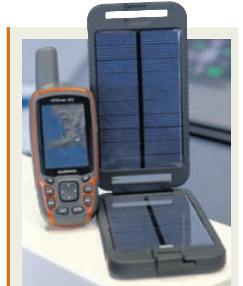
Með Solarmonkey Adventurer frá Powertraveller er hægt að hlaða rafhlöðu í sólarþeglinum yfir daginn. Á kvöldin er svo hægt að hlaða símann, myndavélina eða GPS-tækið eins og til dæmis Garmin Fenix sem er hér með á myndinni.
