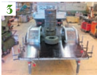
Búið að klæða botngrindina.
