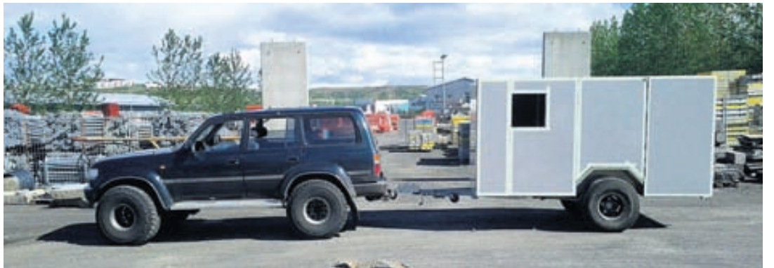
Háfjallahjólhýsið er sterkbyggðara en hefðbundin hjólhýsi, er á stórum dekkjum og smíðað til að þola einstaklega erfiðar aðstæður. Það er ótrúlega létt og vegur ekki nema um 950 kíló.
