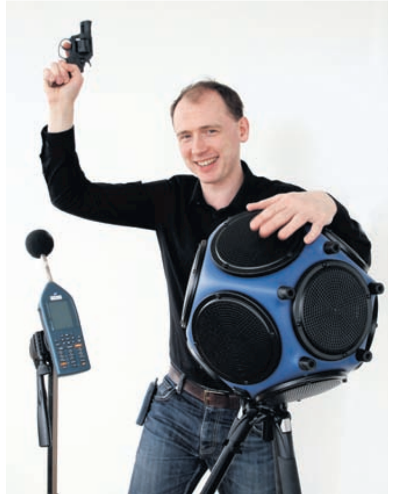
Halldór K. Júlíusson, hljóðverkfræðingur hjá Verkís, með hátalarakúlu, hljóðmæli fyrir mælingar og upptökur á hávaða og titringi og startbyssu fyrir mælingar á hljóðvist og enduróm rýma.
