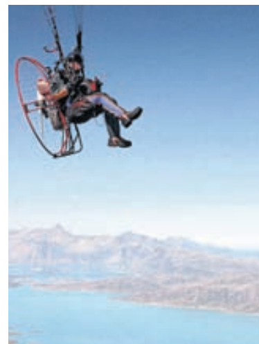
Paramótör er venjulegur svifvængur en sætið er með mótör sem knýr loftskrófu aftan við bak flugmannsins. Með paramótör þarf aðeins stutta atrennu til að hefjast á loft.
