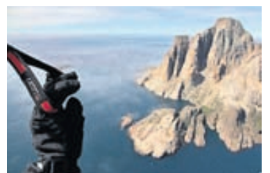
Paramótör er venjulegur svifvængur en sætið er með mótör sem knýr loftskrófu aftan við bak flugmannsins. Með paramótör þarf aðeins stutta atrennu til að hefjast á loft.
