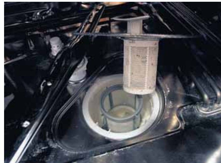
SÍA Í UPPÞVOTTAVÉL Ef sían er ekki hreinsuð þylast óhreinindi um borðbúnaðinn. FRÉTTABLAÐIÐ/PJETUR
