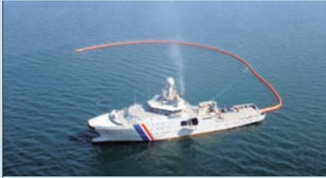
MENGUN Um borð er sérstakur búnaður til mengunarvarna og eins hefur Þór alla eiginleika dráttarskips. Búnaður skipsins gerir kleift að breyta stefnu þó verið sé að draga miklu stærra og þyngra skip.
