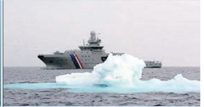
ÍS Þór er sérstaklega styrktur fyrir siglingu í ís og um borð er öflugur eftirlitsbúnaður, t.d. innrauðar myndavélar og næturmyndavélar.
