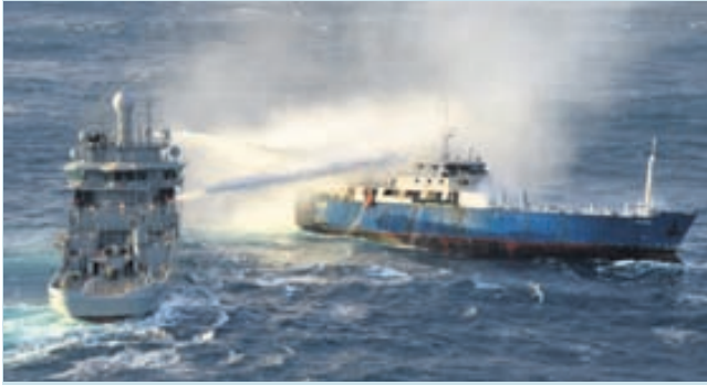
BRUNI Þór er búinn öflugum slökkvibúnaði. Brunadælur skipsins er tengdar við gíra aðalvéla. Hægt er að hylja skipið vatnsúða við slökkvistörf ef þörf er á.
