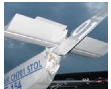
BROTID STÉL Flugvélin endastakkst áður en hún endaði á hjólunum utan flugbrautar. MYND RANNSÓKNARNEFND FLUGSLYSA
