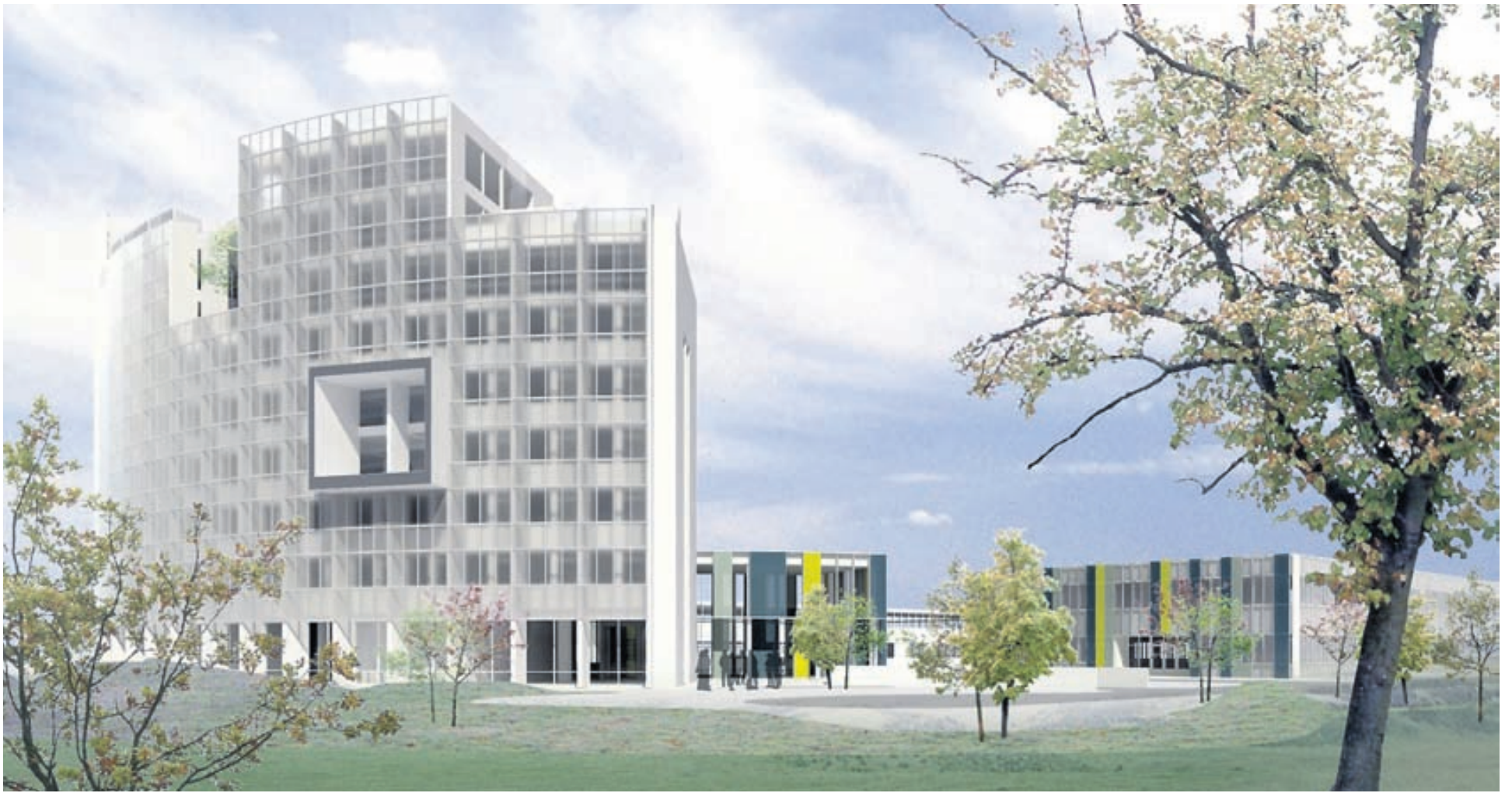
ÁSYNDIN Stóra húsið verður klætt með götötu trefjagleri sem einangrar og hlífir og brýtur niður skæra sólargeisla sem annars glampa á tölvuskjá. Bak við skerminn verður hægt að hafa opna glugga.
