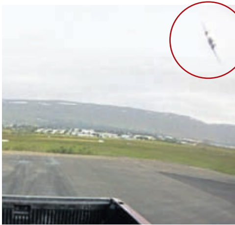
KRÖPP BEYGJA TF-MYX var nánast komin á hliðina er hún kom inn yfir akstursbrautina eins og sést á þessari mynd sem tekin er úr myndavél á þaki spyrnubíls sem útbúinn var tveimur gleiðlinsu myndavélum sem visuðu fram og aftur.
