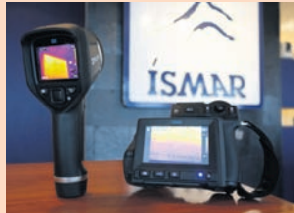
UMBYLTING Hitamyndavélarnar geta numið 0,05 gráðu breytingar á hita. FRÉTTABLAÐIÐ/VALLI
