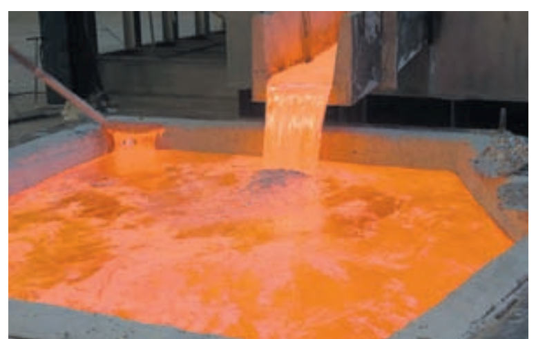
FRÁ FRAMLEIÐSLU SILCOR MATERIALS Fyrirtækið hefur framleitt sólar-kísil með þessari aðferð í rúm tvö ár í tilraunverksmiðju sinni í Kanada þar sem þessi mynd er tekin.
