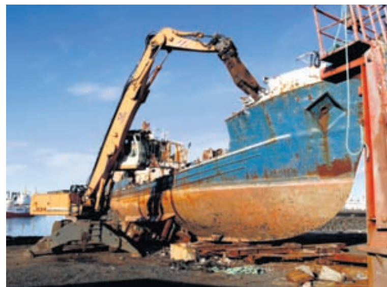
UNNIÐ Á GÖMLU SKIPI Hér er unnið við Kamaröstina í Hafnarfirði. Eflaust verða það örlög margra skipa að verða að nýtanlegum málmum hjá T.S. Shipping á Dalvík. FRÉTTABLAÐIÐ/GVA
