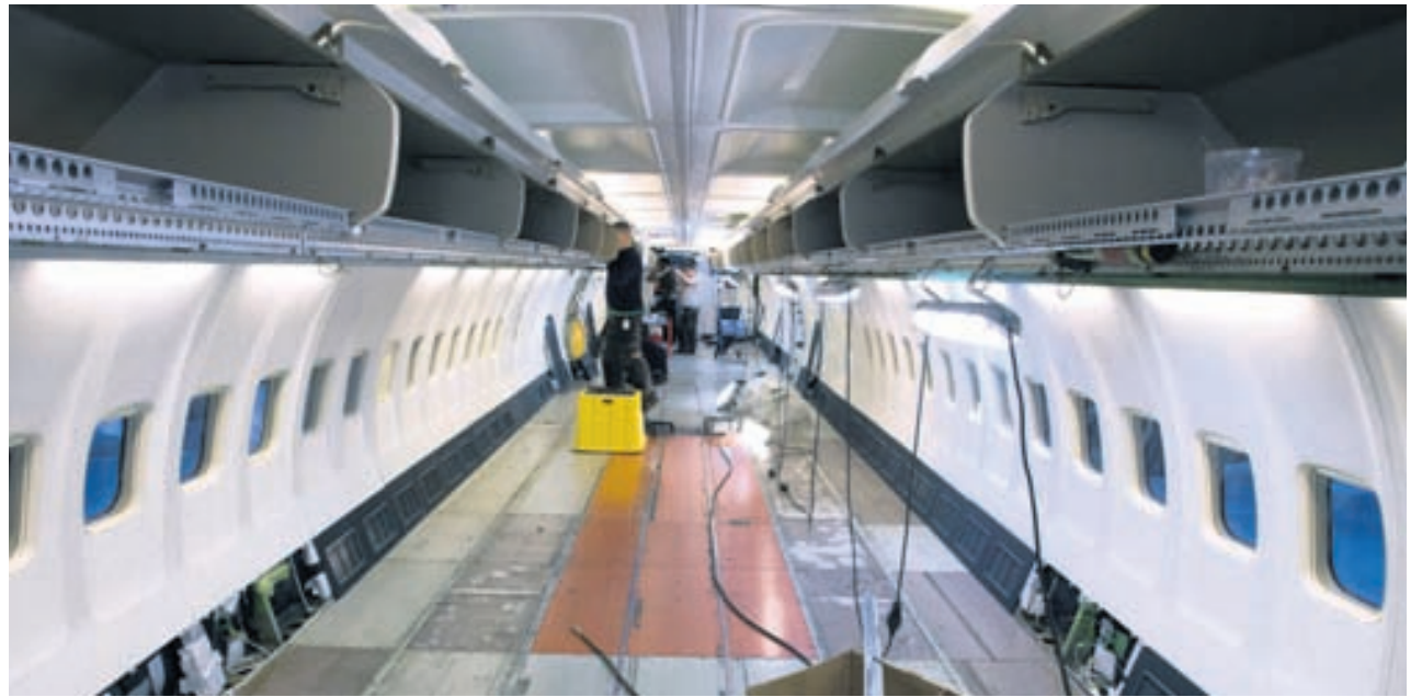
21.09.2014 Búið að hreinsa allt út úr vélinni, öll sæti, panel af veggjum og úr lofti.
