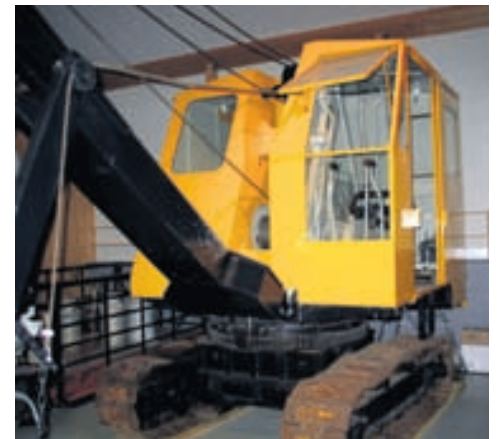
PRIESTMAN WOLF skurðgrafa/ámokstursvél árgærd 1947. Upphaflega í eigu Vegagerðar ríkisins, þá vél nr. 19. Stefán Ananíasarson skóflumaður keypti hana síðar af Vegagerðinni. Vélin var gerð upp 1992-2000 af Vegagerðinni í Borgarnesi. Þessar vélar voru einnig mikið notaðar við skurðgröft um miðja öldina og allt fram yfir 1960, þá með lengri bómu.
