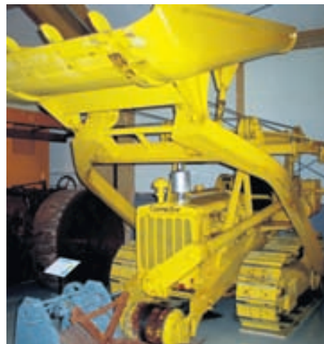
CATERPILLAR D4 DD beltaskófla árgærd 1945. Vélin tók efnið upp fyrir framan sig en sturtaði því aftur yfir sig á vörubíl. Það þótti mikil framför að þurfa ekki að bakka bílnum undir hvern ámokstur. Vélin var í notkun fram á 7. áratuginn og var gerð upp í Borgarnesi 1991-94.
