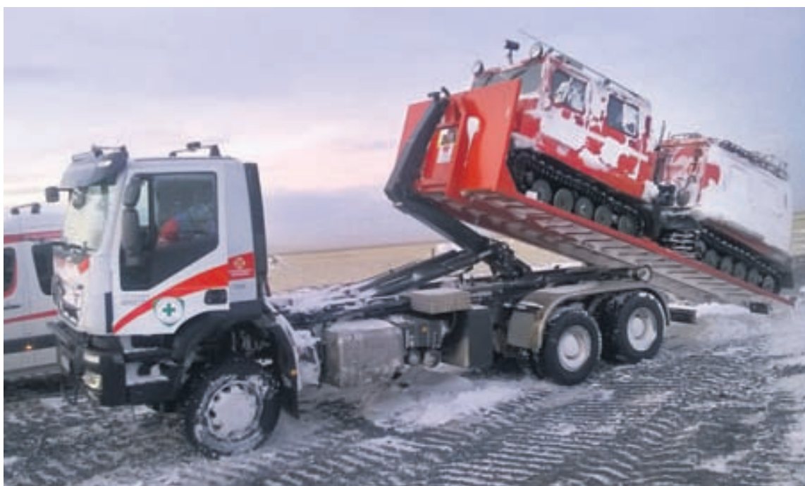
Bíllinn er með krókheisi sem þýðir að hægt er að hífa alls konar einingar upp á hann.
