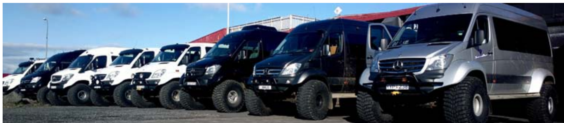
46" breyttir Sprinter bílar. Þessi stærri breyting hefur verið vinsæl, sérstaklega fyrir ferðabjónustuaðila sem sérhæfa sig í ferðum um torfærar leiðir og um jökla landsins.
