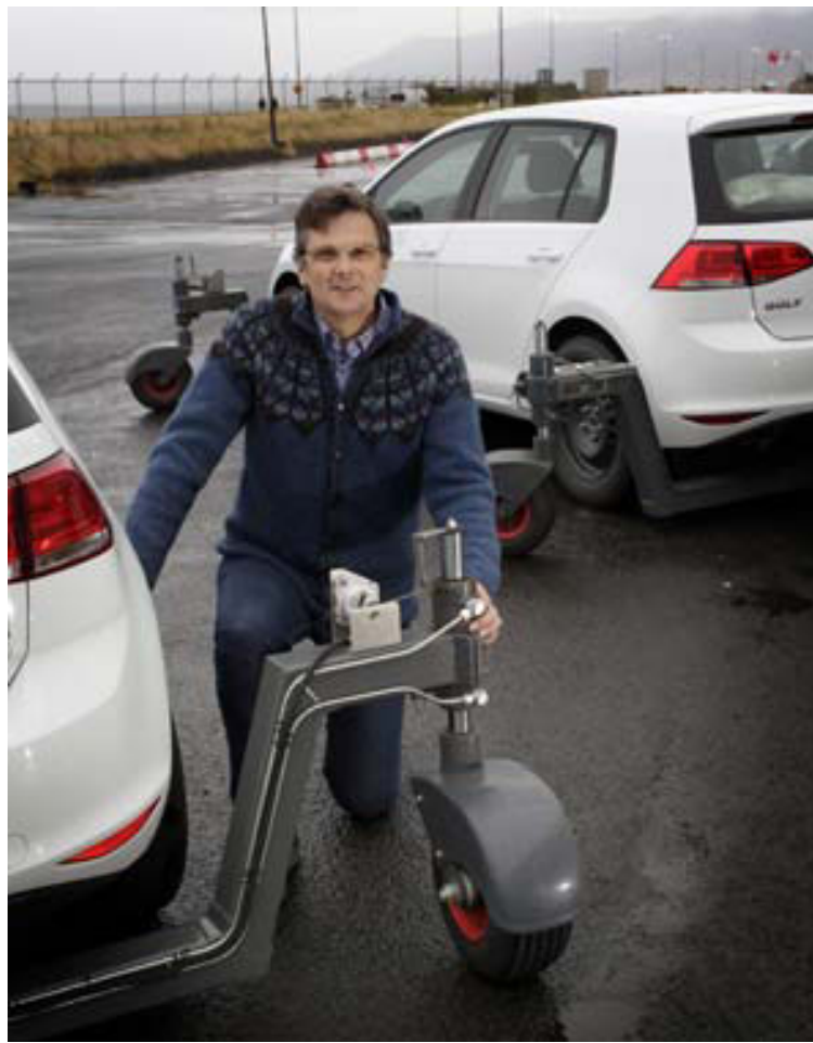
Skrikkíllarnir eru þannig úr garði gerðir að hægt er að stýra veggripinu með því að stilla hversu þungt þeir liggja á götunni.
