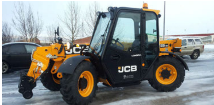
Vélfang kynnr nýjan skotbómulyftara til leiks á þessu ári. Hér er um að ræða smáan en knáan lyftara sem er bara rúmlega 1,8 metrar á hæð og breidd og fer auðveldlega inn í gáma og getur lyft 2,5 tonnum í 6 metra hæð. Hann nær 40 kílómetra ökuhraða og er með fjaðrandi lyftigálga.
