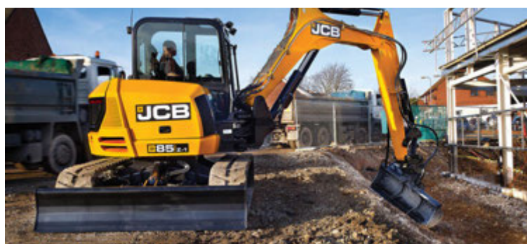
Nýjar mini/midi gröfur koma endurhannaðar frá grunni, eru til dæmis með vökvaskykkjanlegum tönnum, mun rýmra húsi, nýjum dísilvélum úr samstarfi JCB og Kohler í Austurríki.
