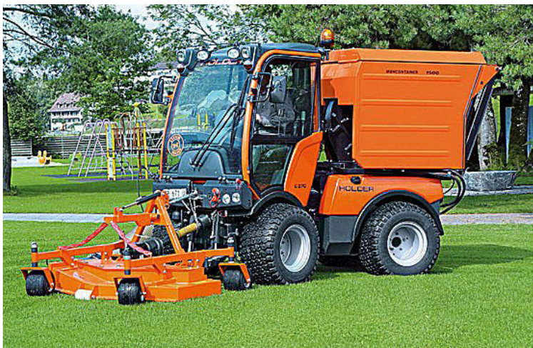
Holder-bíll með sláttuvél á grasi. Á þessum bíla er hægt að setja fjöldann allan af aukahlutum svo sem sláttuvélar, snjóblásara, snjótennur, salt- og sanddreifara, gangstéttarsóp, gervigrasþvottavélar og háþrýstivélar svo eitthvað sé nefnt.
