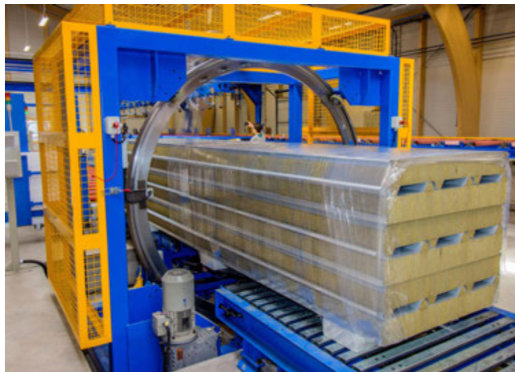
Hér má sjá sjálfvirkan pökkunarbúnað fyrir nýju einingarnar.
