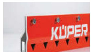
Slitblöð á snjótennum, karbít og keramik
