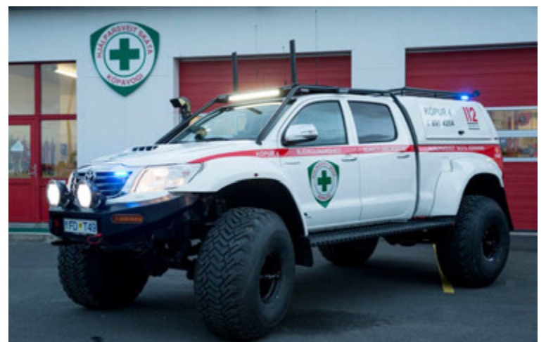
Nýi hjálparveitarbíllinn hjá Hjálparveit Kópavogs sem breytt var af Breyti. Settar voru hásingar úr Nissan Patrol undir bílnum.
