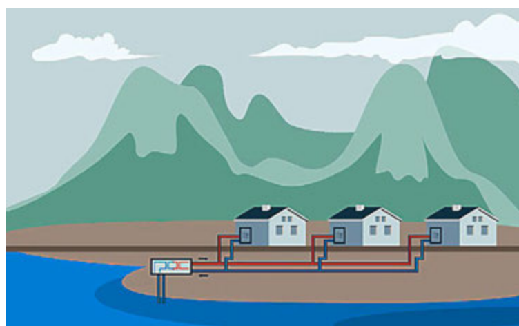
Sjóvarmadæla og hitaveita. MYND/COWI
