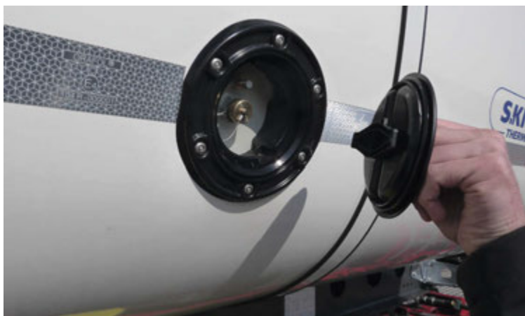
Tvö op eru á sitt hvorri hlið malbiksvagnanna þar sem hægt er að mæla og fylgjast með hitanum í malbikinu.
