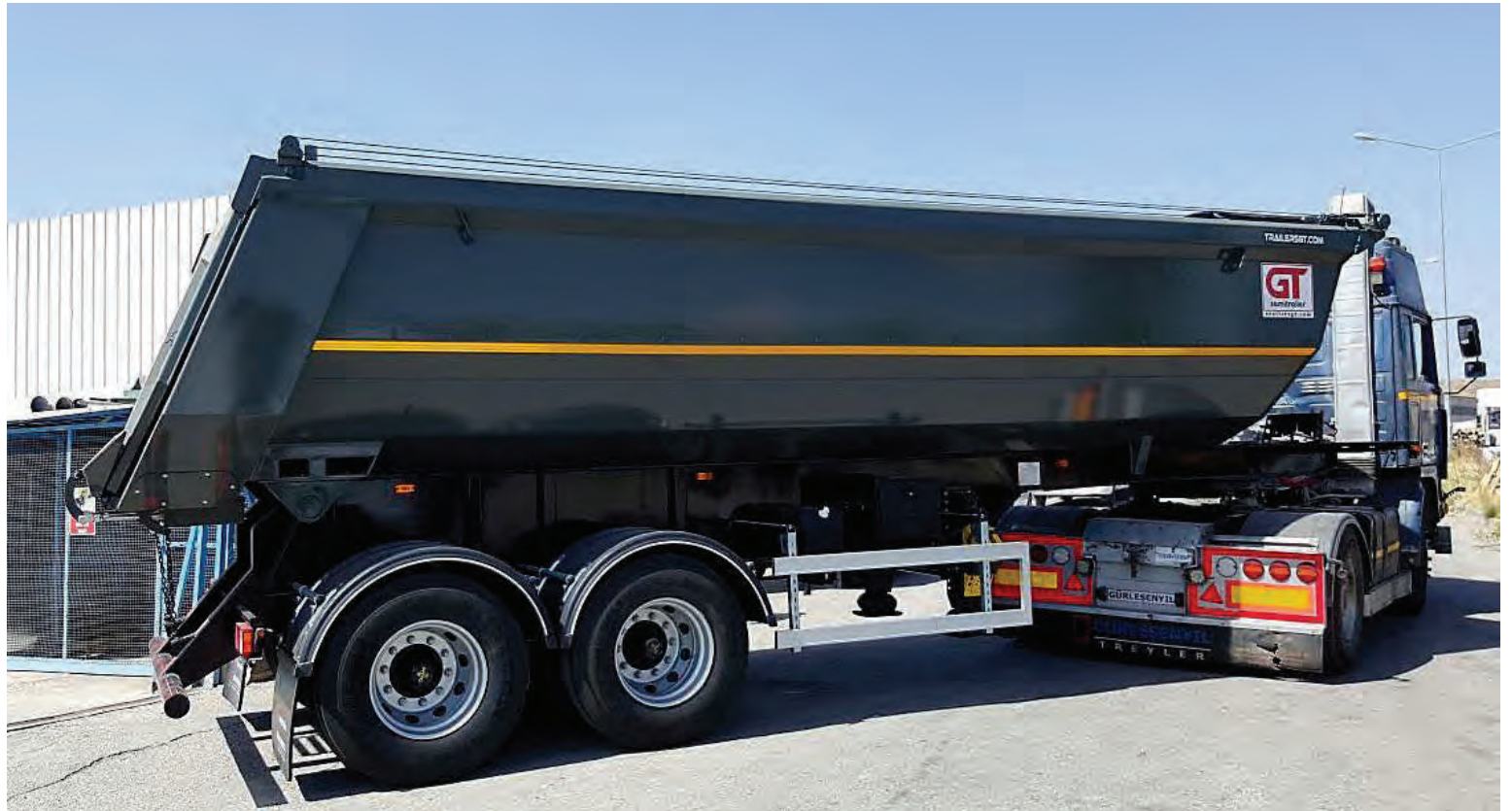
24 m³ malarvagn frá GT með 8 mm hardox í botni og 6 mm í hliðum.
