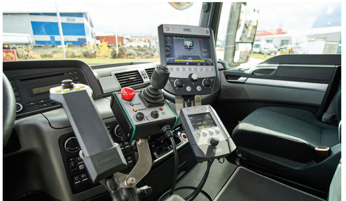
Hér má sjá nýjan stjórnbúnað í íslensku fyrir sand- og salt-dreifara og nýjan stjórnbúnað fyrir tennur með léttibúnaði.
