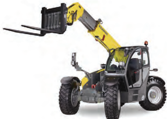
Fjór hjólastýrðir skotbómulyftarar með lyftigetu frá 800 kg upp í 4.990 kg og lyftihæð frá 3,9 m upp í 8,75 m.
