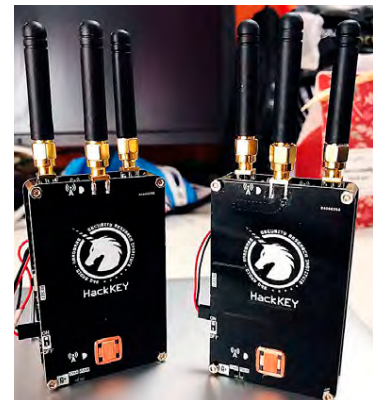
Hér má sjá dæmi um búnað til að opna bíla með þessum hætti sem tækniöryggisfyrirtækið Quihoo 360 smíðaði fyrir lítið fé.
